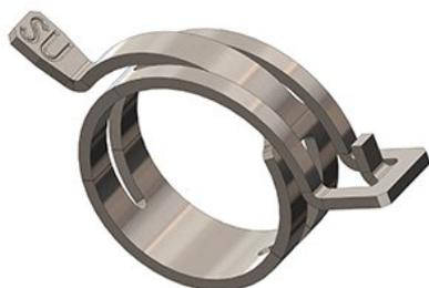
As abraçadeiras do tipo MOLA oferecem tensão constante, e por isso são recomendadas para aplicações onde existem variações de temperatura e pressão, ou ainda acomodações do material da mangueira. Fabricadas em material cromo vanádio (51CrV4).
