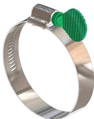
As abraçadeiras da linha FLEXIL® com manipulador "borboleta" são sugeridas para conexões em que é possível a aplicação do torque manualmente, ou seja, vedações e fixações que sejam atendidas com baixo torque de instalação. Manipuladores em aço revestidos com Geomet.
