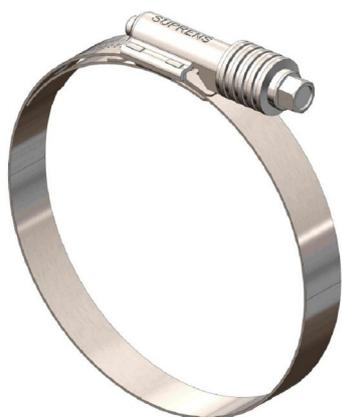
As abraçadeiras da linha FLEXIL SUPER COM MOLA têm alta performance de aperto, possuem proteção da região roscada (ponte) e sistema de molas prato que proporcionam um aperto constante, compensando pequenas variações nas dimensões devido as mudanças de temperatura ou acomodação da mangueira. São recomendadas para uso em locais onde há necessidade de alta performance de aperto, sistemas de arrefecimento (intercoolers) e linha diesel.
