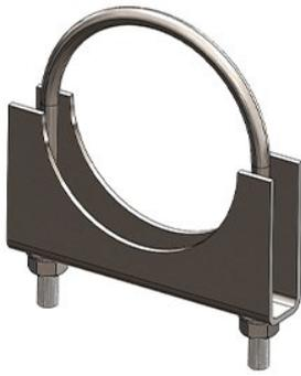
As abraçadeiras da linha “U” são recomendadas para uso em escapamentos de automóveis, caminhões, tratores, fixação de antenas e tubulações, possuindo grande resistência mecânica. São fornecidas com arruelas de pressão, disponíveis em aço carbono, sendo o cavalete zincado e o grampo bicromizado em aço, com alto teor de carbono proporcionando o maior torque dos existentes no mercado.
