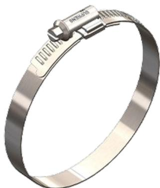
As abraçadeiras CRON são recomendadas para uso em mangueiras de material semi rígido, possuem grande capacidade de aperto e dimensões reduzidas. O deslocamento do conjunto rosca/parafuso proporciona equilíbrio durante aplicação do torque e conseqüentemente a obtenção de maiores forças radiais.
