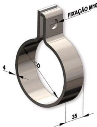
As abraçadeiras do tipo TIGRE são utilizadas em conexões entre tubos sem ressaltos. São usualmente empregadas nas junções dos sistemas de exaustão de veículos comerciais e de instalações industriais. Fabricadas em fitas de aço carbono estrutural, com isso, possuem grande capacidade de aperto/fixação.
