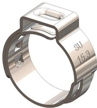
As abraçadeiras da linha RADIAL por não apresentarem degraus e/ou desníveis em seu interior, não danificam as mangueiras. São utilizadas na indústria automobilística (dutos de combustíveis) e em sistemas hidráulicos submetidos a altas pressões. Aplicadas com alicates especiais, apresentam circularidade perfeita e constante distribuição das forças radiais, garantindo perfeita vedação do sistema. Possuem grande capacidade de resistência à corrosão.
